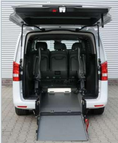
En dépliant la rampe, le véhicule devient facilement accessible en fauteuil roulant.
