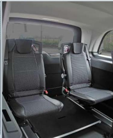
Des sièges pivotants et rabattables en option sur la 3ème rangée permettent une utilisation flexible du véhicule.
