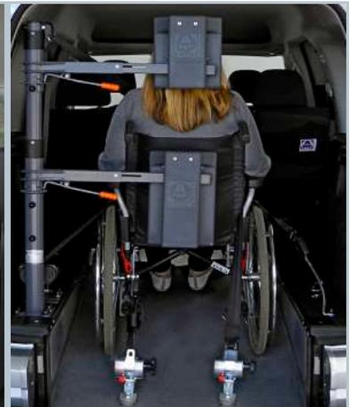
Le véhicule est équipé de l'appui-tête et du support dorsal FUTURESAFE.
