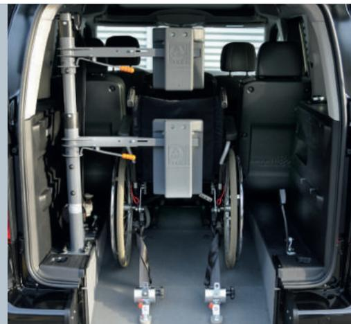
Le véhicule est équipé de l'appui-tête et du support dorsal **FUTURESAFE**.
