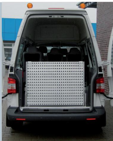
Véhicule avec rampe rabattue. La visibilité vers l'arrière est maintenue.
