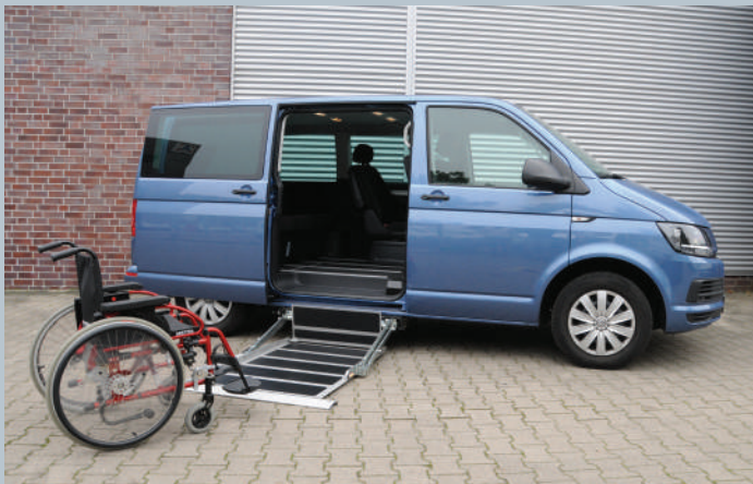
Die seitliche Auffahrmöglichkeit mit der flacher Seitenkante der Liftplattform spart Platz bei der Auffahrt mit dem Rollstuhl.
