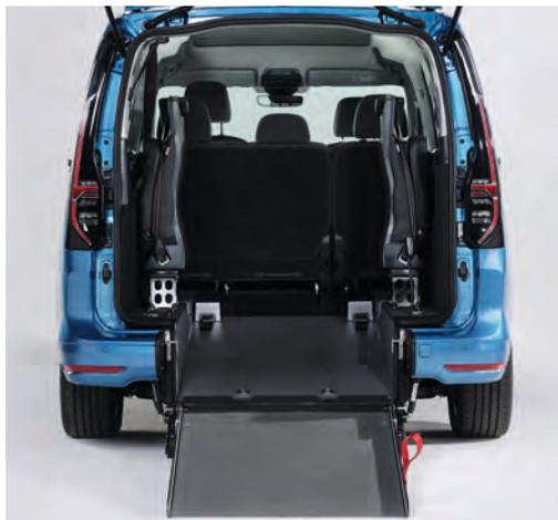
Lorsque la rampe est dépliée, le véhicule peut facilement être conduit avec le fauteuil roulant.
