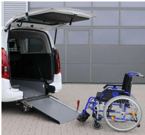
Lorsque la rampe est dépliée, le véhicule est très facilement accessible en fauteuil roulant.
